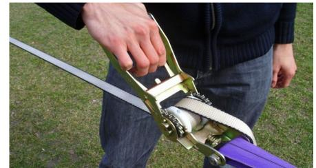
In diesem Zustand (Hebel in der Ratsche angezogen) drücken wir den großen Griff in Richtung Slackline. Dadurch befreien wir die Zahnräder und die Walze löst sich ruckartig. Vorsicht mit den Fingern!
